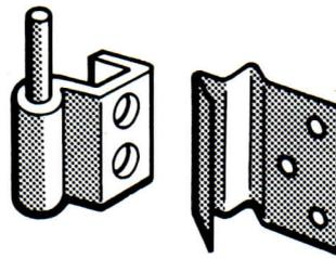
**Tür- und Klappenscharnierteile**
