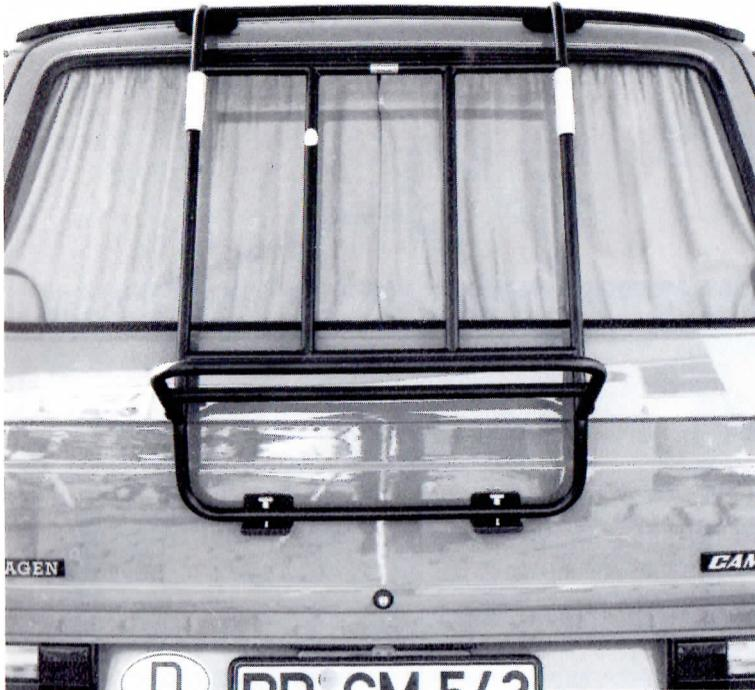
**Der Grundträger** für alle weiteren Anbau-Systeme aus verzinkten Stahlrohr, 22 mm Ø und Kunststoffbeschichtet.
