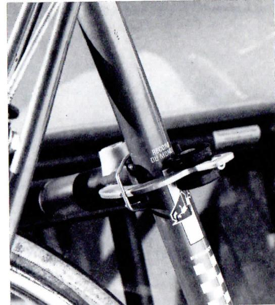
Verstellbare Klemmrollen-Befestigung der Profi-Fahrrad-Halterung in Aktion. Idealer Befestigungspunkt ist das Sattelrohr.
