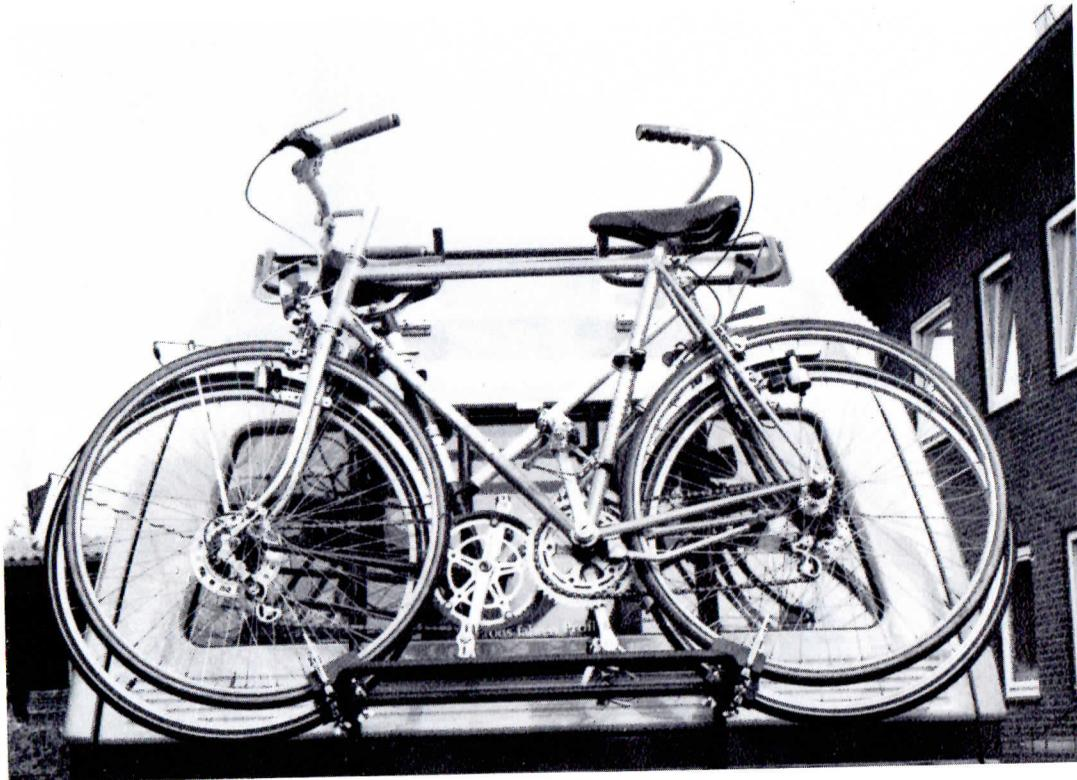
Der **Grundträger** ermöglicht den Transport von 2 Fahrrädern.
