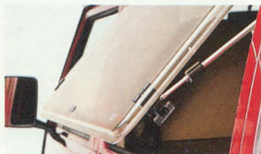
Unterstützt die Frischluftventilation: das ausstellbare Acrylglassolierfenster.
